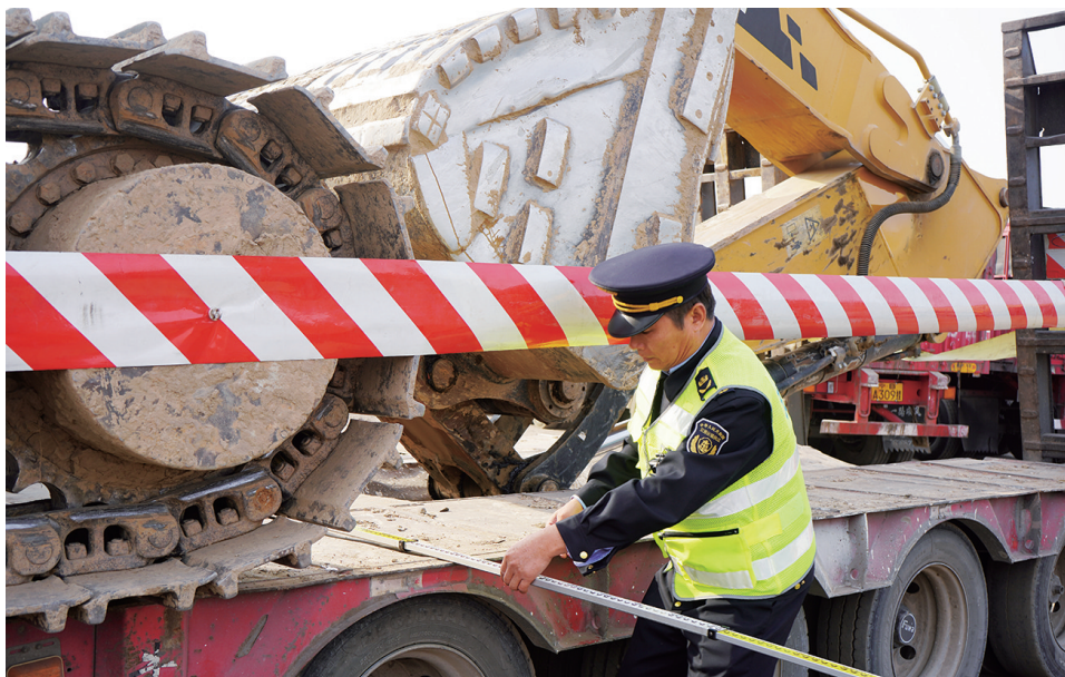
对大件运输车辆外扩尺寸进行测量。
