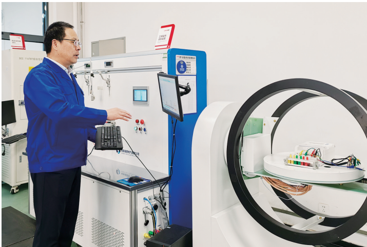
常兴智在做三相电能表工频磁场实验。受访者供图
